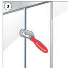
Ejercer una presión uniforme para obtener una buena adhesión y evitar burbujas de aire.
