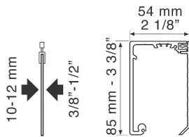
Está diseñado para instalar dos paneles de vidrio correderos enfrentados con apertura sincrónica a una pared de cristal permitiendo deslizar las puertas de manera simultánea para conseguir mayor iluminación y luz de paso.
