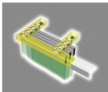
Es un sistema para hojas correderas plegables de hasta 150 Kg. por hoja para vidrio de 10 a 12 mm de grosor. El modelo se caracteriza de nuevo por su zona de estacionamiento de las hojas conocida como "parking". Dicho "parking", en este modelo, es de 90° o perpendicular y esto permite la mas amplia gama den variantes de instalación haciéndolo flexible y pudiéndose adaptar a cualquier espacio.
