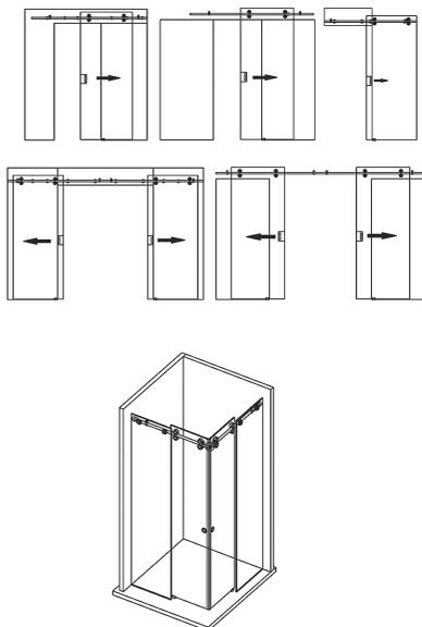
Se trata de un mecanismo de divisiones y puertas de vidrio, con dos rodamientos de acero inoxidable, para puertas correderas de cristal, de hasta 120 Kg. de peso, para vidrios de entre 10 y 12 mm. especialmente indicado para instalaciones de duchas en baños.
