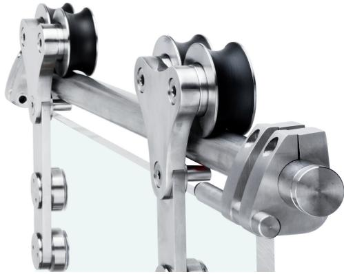
Es un sistema de hojas correderas de hasta 240 Kg. de peso por hoja para vidrios de entre 10 y 12 mm en acero inoxidable. El perfil superior de forma circular tiene la robustez para soportar el peso de distintas hojas colocando los soportes en los lugares indicados. Las roldanas dobles son de rodamientos a bolas y de acero inoxidable.
