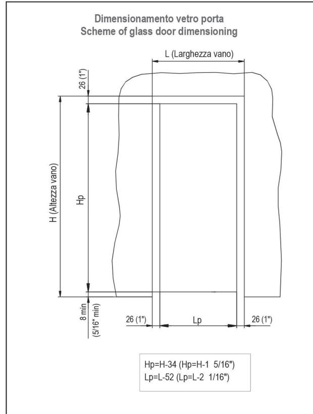
Formule di taglio profili - Fórmula de corte de los perfiles - Profiles cut formula - Profilsansicht - Formule de coupe des profils
