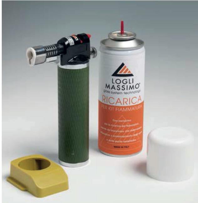
Juego para tratamiento con llama. Para tratamiento del vidrio, cristal, metales, antes del encolado. Mejora y aumenta la adhesión entre vidrio-vidrio, vidrio-metal. Fix Fire elimina humedad, suciedad y aceite de cualquier superficie tratada con chorro de arena, con ácido, templada o con vidrios de alto contenido de plomo tales como los sopladros. Principalmente en el periodo invernal la humedad puede obstaculizar la adherencia de los adhesivos.
